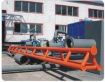
管排架 Pipe Rack
