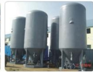
水泥库干灰混拌装置 Dry cement mixing unit
