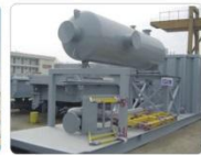
油水分离器 Oil/water separator
